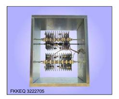
Stahlgitterfestwiderstandsgerät in Schutzart IP 00 eingebaut in Kanalstück zur bauseitigen Integration in bestehende bzw. neue Abluftanlagen, im verzinkten Stahlblechkanal mit angebautem Klemmenkasten und optionalem Temperaturschalter.
