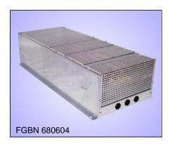
Drahtgewickeltes Lamellenfestwiderstandsgerät in Schutzart IP 20<sup>0</sup>, verzinkten Stahlblechgehäuse, mit keramikisolierten Flachklemmen bis 35 A und keramikisolierten Bolzenklemmen für größere Ströme im Geräteinneren. Mit Bohrungen für 3 Kabeleinführungen PG 13,5, die durch Gummitüllen verschlossen sind.
